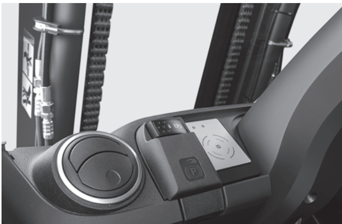
In jeder Lage ein perfekter und sicherer Halt dank elektrisch-hydraulischer Feststellbremse
