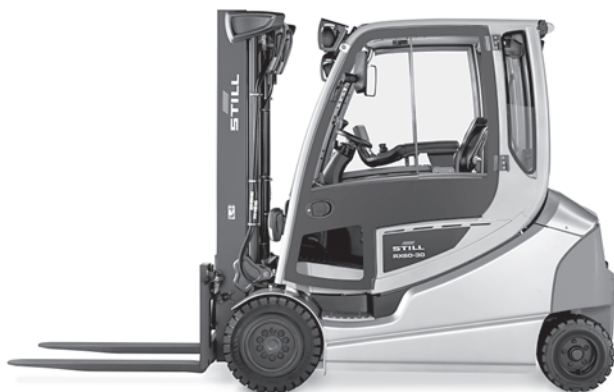
Vollkabine für Außeneinsätze bei jedem Wetter
